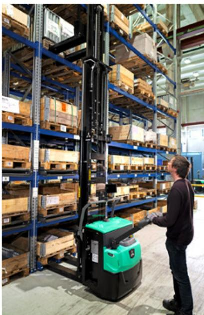
La AXiA ES no se ve afectada por la suciedad, residuos, polvo o agua gracias a su chasis protector sellado y sus componentes estancos al agua (índice de protección IP54), por lo que trabaja con total fiabilidad tanto en interiores como en exteriores con un mantenimiento mínimo.
