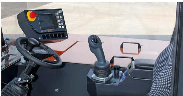
La operación de todos los movimientos hidráulicos, al igual que la preselección de la dirección de conducción de serie se realiza mediante el joystick multifunción ergonómico. La columna de dirección de altura ajustable e inclinable ofrece mayor comodidad al operario.
