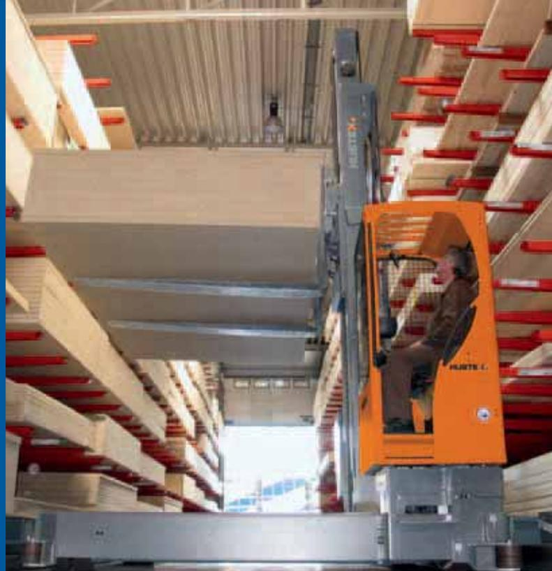
Nosotros ofrecemos carretillas multidireccionales eléctricas con capacidades entre 1.5 y 20 t, para todo tipo de sectores donde se trabaje con cargas largas o voluminosas, en aplicaciones tanto de exterior como de interior y apilado en estantería como en bloque, minimizando los pasillos de trabajo. También ofrecemos soluciones personalizadas.
