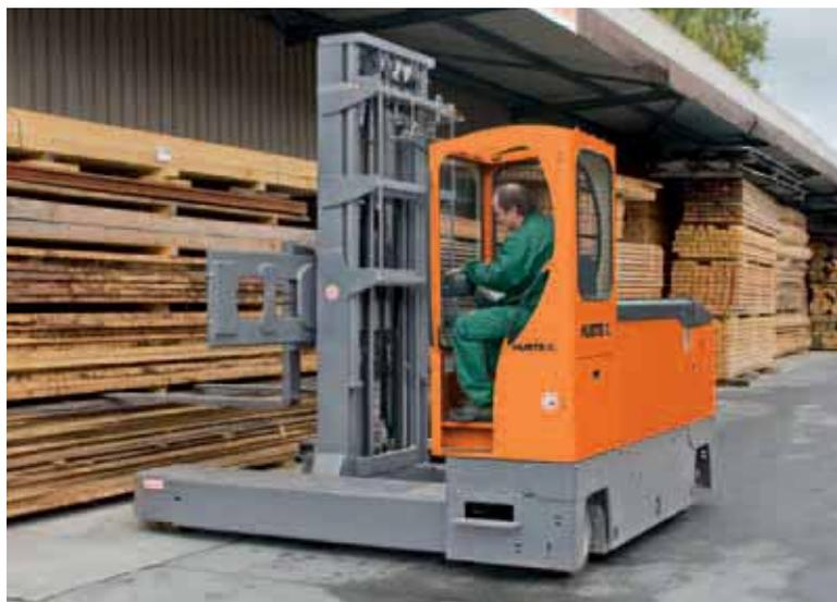
Estas series ofrecen tanto ruedas de Vulkollan (PU) para aplicaciones de interior, como de ruedas elásticas (EL) para un uso mixto (interior–exterior). Ambas series van equipadas con motores de tracción en posición vertical en compartimentos estancos, protegidos de humedades y polvo, lo que permite utilizarla en situaciones de mal tiempo.
