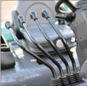
Palancas de control hidráulico
