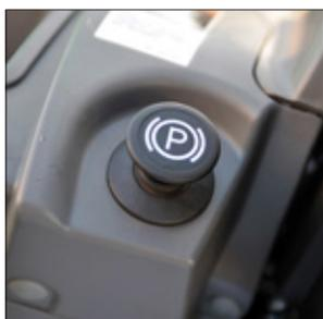
Freno de estacionamiento controlado electrónicamente
