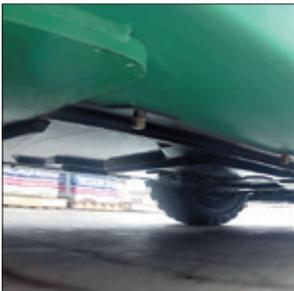
Construcción con placa protectora inferior
