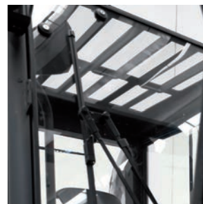
Luna delantera y techo con escobillas limpiaparabrisas
