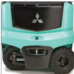
Eje trasero con más de 100 grados de giro
