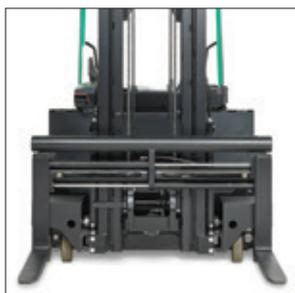
Amplio posicionador de colocación/inclinación de horquillas
