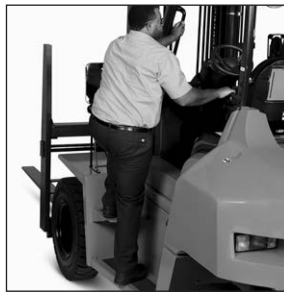
Escalón de fácil acceso y asidero de apoyo
